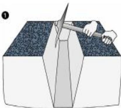
1 Creusez une tranchée aux dimensions requises à l'aide d'une pioche et d'une pelle ou en louant une mini pelle en cas de grande distance.
