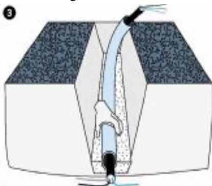
3 Placez le conduit équipé du câble sur le lit de sable.
