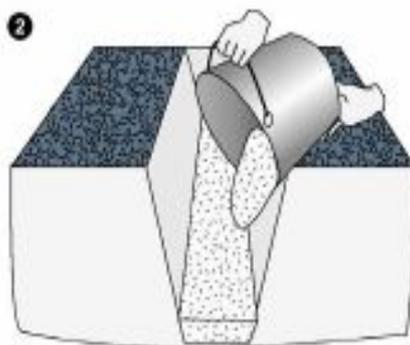
2 Déposez une couche de 15cm de sable au fond de la fouille.
